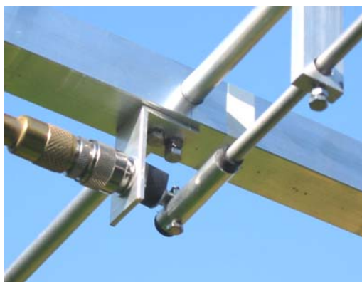
Le réglage se fait au moyen d'un gamma-match.
