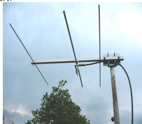
Le réglage se fait au moyen d'un gamma-match.
