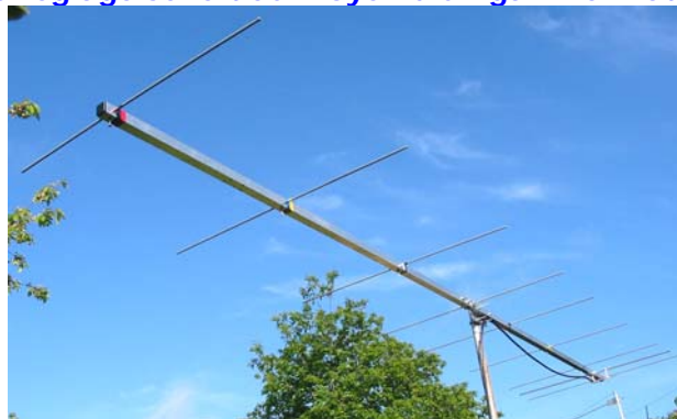
Le réglage se fait au moyen d'un gamma-match.
